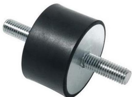
Виброизолирующая опора (амортизатор резинометаллический) RUICHI предназначена для монтажа вибростолов, трубопроводов, воздухопроводов и различных, рабочих агрегатов и систем, для которых требуется устранение нежелательной вибрации. Стандартное исполнение твердости — 55 единиц по Шору. Изделие выполнены из натурального каучука, и конструкционной углеродистой стали с оцинковкой.
