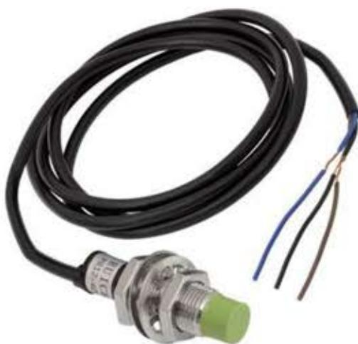
Индуктивный датчик RUICHI PR12-4DN-R нормально открытый, размер M12, зона срабатывания 4мм используется для определения наличия объектов из ферромагнитных металлов (железо, никель, кобальт и их соединения с другими металлами). Датчик обладает высокой чувствительностью и может обнаруживать не только большие, но и мелкие предметы. Работает в широком диапазоне температур. Датчик имеет компактный размер и легко монтируется на различные поверхности через отверстия в корпусе.
