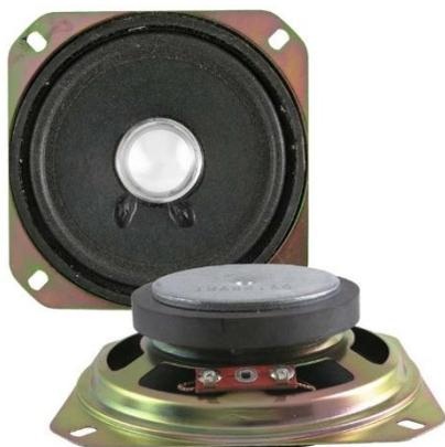
Акустический динамик RUICHI YD103-12, 10 Вт, 8 Ом – устройство, преобразующее электрические сигналы в звуковые, путём перемещения катушки с током в поле постоянного магнита с последующим преобразованием механических колебаний в колебания окружающего воздуха с помощью диффузора.
