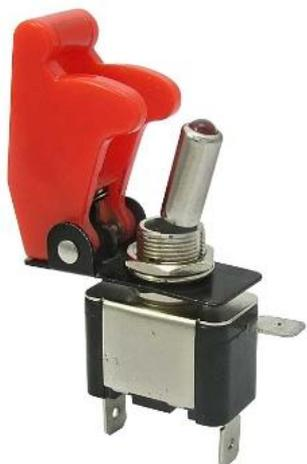
Тумблер двухпозиционный однополюсный RUICHI ASW-07D с красным предохранительным колпачком RUICHI SAC-01, 61.7x16x28 мм. ON-OFF, SPST, 25 А, 12 В, 50 мОм, 3 контакта, под пайку, с красной LED индикацией - это малогабаритный переключатель на два либо три положения с рычажно-пружинным приводом. Применяется главным образом для коммутации цепей управления.
