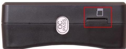
Рис. 24 Установка карты в MicroSD слот
