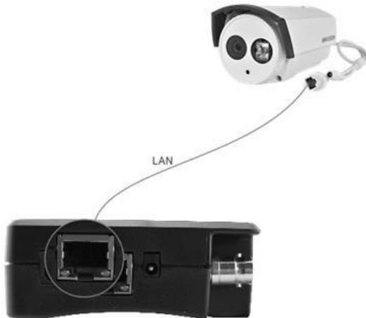
Рис. 10 Подключение ip-видеокамеры
