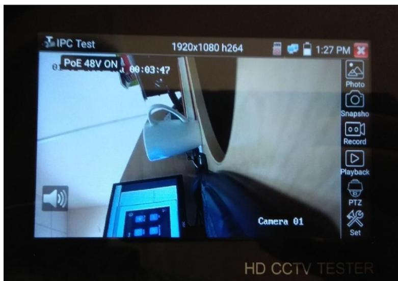
Рис. 17 Пример успешного подключения IP-видеокамеры к тестеру
