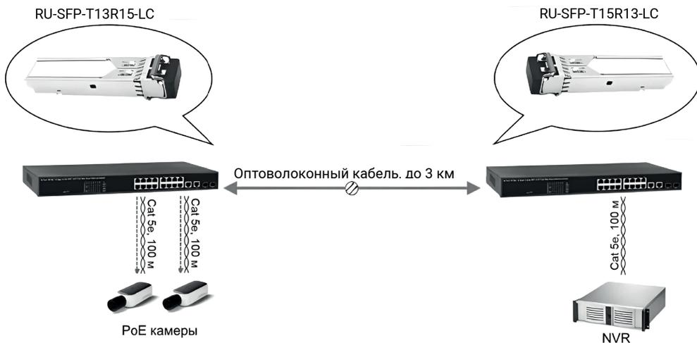
Рис.6 Типовая схема подключения SFP модулей RU-SFP-T13R15-LC, RU-SFP-T15R13-LC
