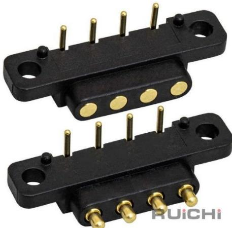
Разъем питания подпружиненный RUICHI POGO pin, 4 контакта, комплект male-female, шаг 2.54 мм, с фланцами для крепления к панели мобильных устройств с постоянным током.
