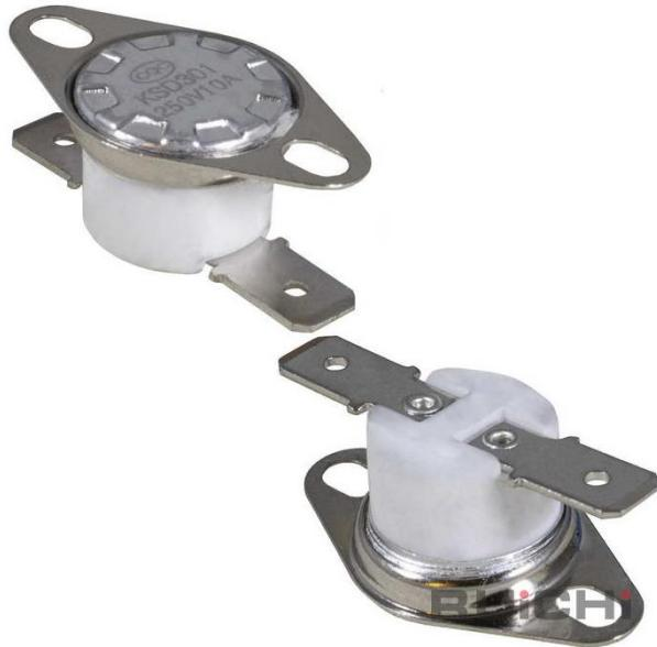
Термостат нормально замкнутый NC RUICHI KSD301, 260 °C, 10 A, 250 В, 100 мОм, длина выводов 8.5 мм, керамический - это контакт, который при нагреве выше температуры определенной температуры размыкает электрическую цепь. Они используются в конструкции различных электроприборов, предполагающих нагрев, таких как водонагреватели (бойлеры), электроплиты, духовые шкафы, электро котлы, обогреватели, микроволновки, стиральные машины.
