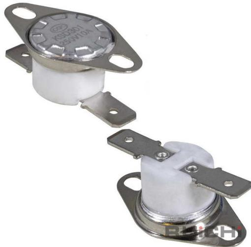
Термостат нормально замкнутый NC RUICHI KSD301, 250 °C, 10 A, 250 В, 100 мОм, длина выводов 8.5 мм, керамический - это контакт, который при нагреве свыше температуры определенной температуры размыкает электрическую цепь. Они используются в конструкции различных электроприборов, предполагающих нагрев, таких как водонагреватели (бойлеры), электроплиты, духовые шкафы, электро котлы, обогреватели, микроволновки, стиральные машины.
